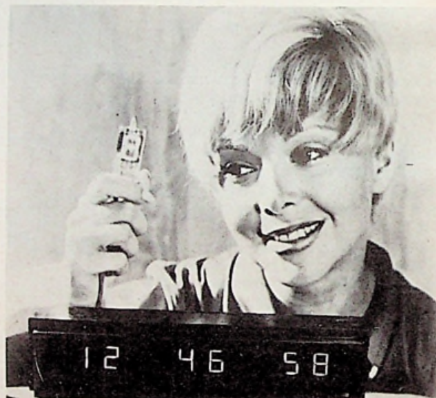
De Numitron indicatorbuis toegepast in een digitale klok die uren, minuten en seconden aangeeft.
